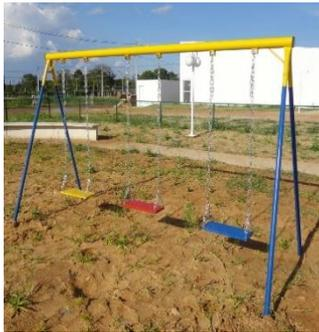
Confeccionado em tubo de aço, resistente ação do tempo (sol e chuva), cano de 2,5" e pintura epóxi (eletrostática) que possui uma durabilidade maior que tinta comum. Assento em aço galvanizado e madeira de eucalipto com pintura sintética automotiva colorida.
